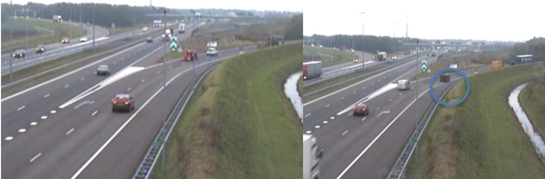
Figuur 2.2: Reacties bij onverwachte boog door abrupt remmen en uit de rijstrook geraken bij knooppunt Galder (Lambers, 2013a)
